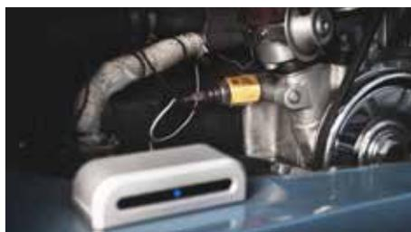
Abbildung 2: hoots | one Hauptsystem und Ölsensor
