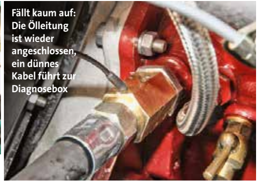
...den wir beim MG-Motor am Ölkanal-Ausgang der außenliegenden Leitung zum Ölfilter montieren
