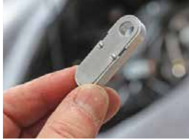
Die Sensoren für die Oberflächentemperatur lassen sich wahlweise mit einer Schraube oder einem Metallkabelbinder befestigen. Wir platzieren einen Fühler am oberen Anschlussstutzen des Kühlers
