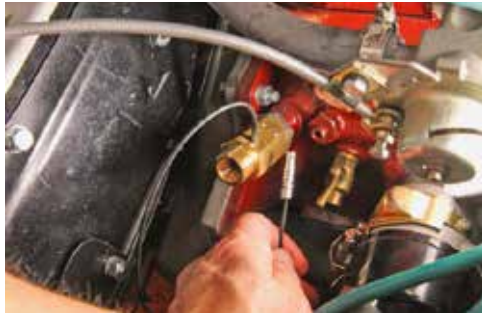
...den wir beim MG-Motor am Ölkanal-Ausgang der außenliegenden Leitung zum Ölfilter montieren
