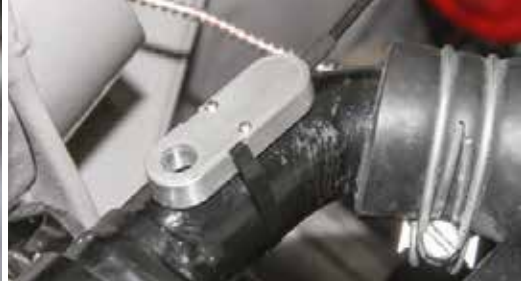
Die Sensoren für die Oberflächentemperatur lassen sich wahlweise mit einer Schraube oder einem Metallkabelbinder befestigen. Wir platzieren einen Fühler am oberen Anschlussstutzen des Kühlers
