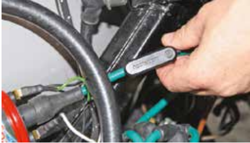
Den Drehzahlsensor installieren wir am Hochspannungskabel zwischen Zündspule und Verteiler
