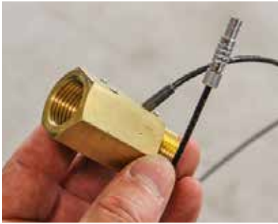
Der Fühler für Öldruck und -temperatur sitzt im Einschraubadapter für die Ölleitung,...
